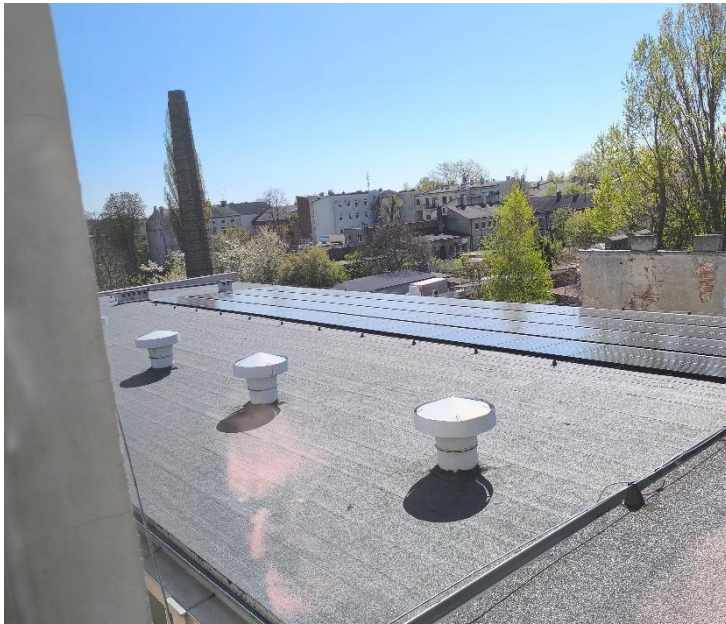
Instalacja fotowoltaiczna zamontowana na dachu sali gimnastycznej I LO w Zduńskiej Woli.
